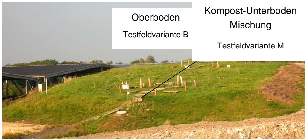
Bild 1 Testfeld mit installierten Messgeräten; linke Hälfte: „Oberboden“-Variante (Bereich B), rechte Hälfte: „Kompost-Unterboden Mischungs“-Variante (Bereich M)
